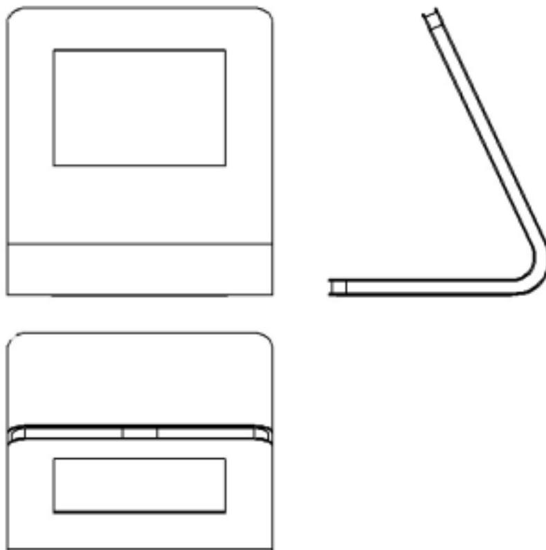
Abb. 1: TabLines TTS Design Tischständer
